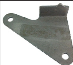
GCO-050 N.O.: 352 032 17 15 MOSTRADOR DE PONTO DO VIRABR 18° OM352/1113/1513
